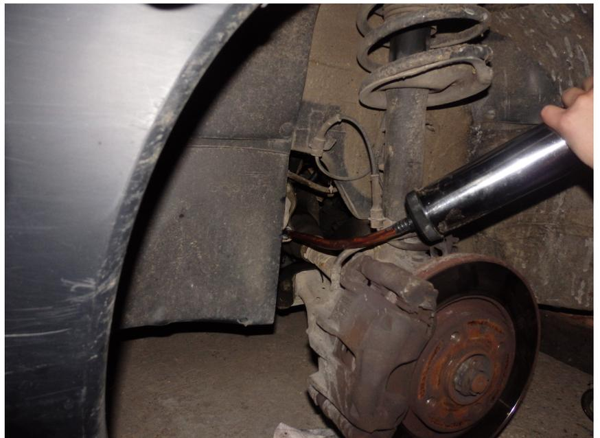
La seringue système D : Prendre un tuyau fin de 2m environ raccordé à un petit entonnoir et se mettre en hauteur pour verser l'huile.
