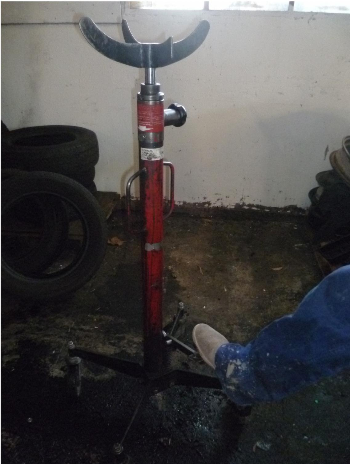
Le levier au pied permet de monter la pièce et la molette a droite permet de la descendre.
